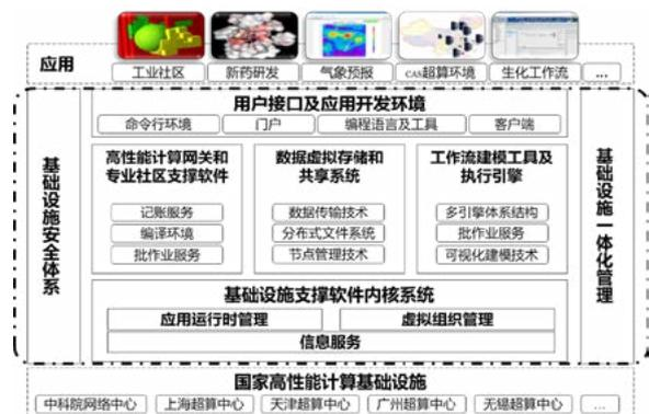
图2 CNGrid Suite系统架构
