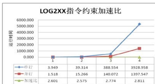
图3 LOG2XX指令约束求解模型并行加速示意图
