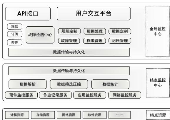
图4 一体化基础设施监控管理体系结构框架
