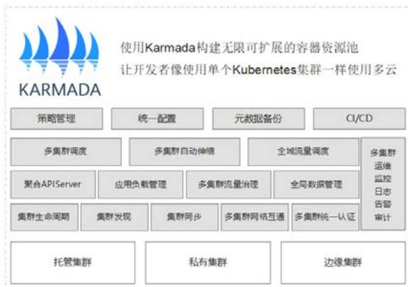
Karmada是由华为开源的多云编排框架，是CNCF的云原生沙箱项目，结合了华为云容器平台MCP以及Kubernetes Federation核心实践，并融入了众多新技术：包括Kubernetes原生API支持、多层次高可用部署、多集群自动故障迁移、多集群应用自动伸缩、多集群服务发现等，并且提供原生Kubernetes平滑演进路径，让基于Karmada的多云方案无缝融入云原生技术生态，为企业从单集群到多云架构的平滑演进方案。Karmada的优势主要有以下几点：
