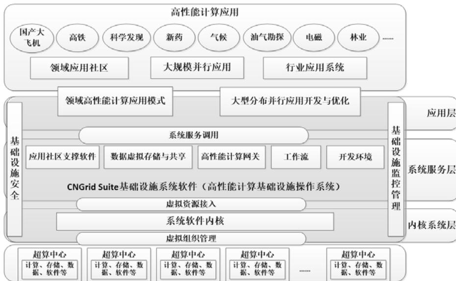
图1 国家高性能计算基础设施的非集中层次虚拟化体系结构
