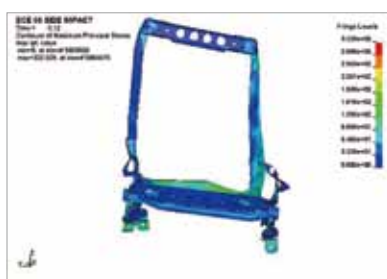
座椅系统最大应力仿真结果
