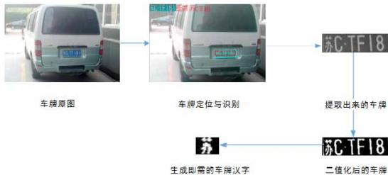
图6 拍摄车牌图片的汉字提取过程
