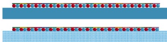
图13 浮桥的初始及平衡位置
