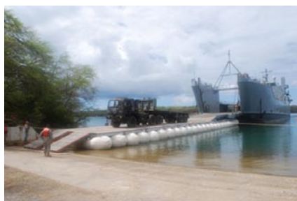
图1 囊式浮桥示例
