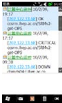
图6 整合的网格监控系统：(A) 网络节点的实时状态 (B) 手机短信报警
